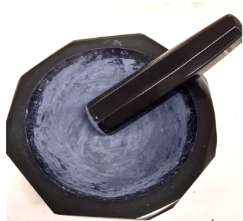
Kompozit előállítása 98% TiO 2 + 2% CNT-COOH
