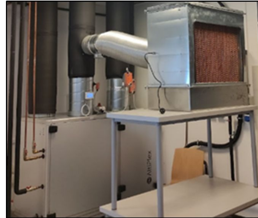
Evaporatív léghűtő külső váza, Debreceni Egyetem Műszaki Kar Légtechnikai Laboratórium Forrás: Balogh et al., 2025
