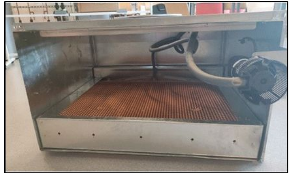
Evaporatív léghűtő, lecsapató panel és szivattyú
