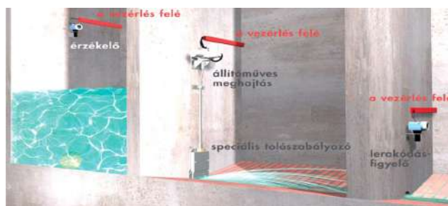
12. ábra ElektroSlide lefolyásszabályozó (Steinhardt GmbH. – Gyártmánykatalógus)
