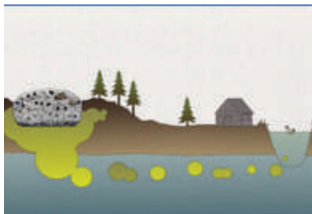
Hulladékdepóniából származó csurgalék
