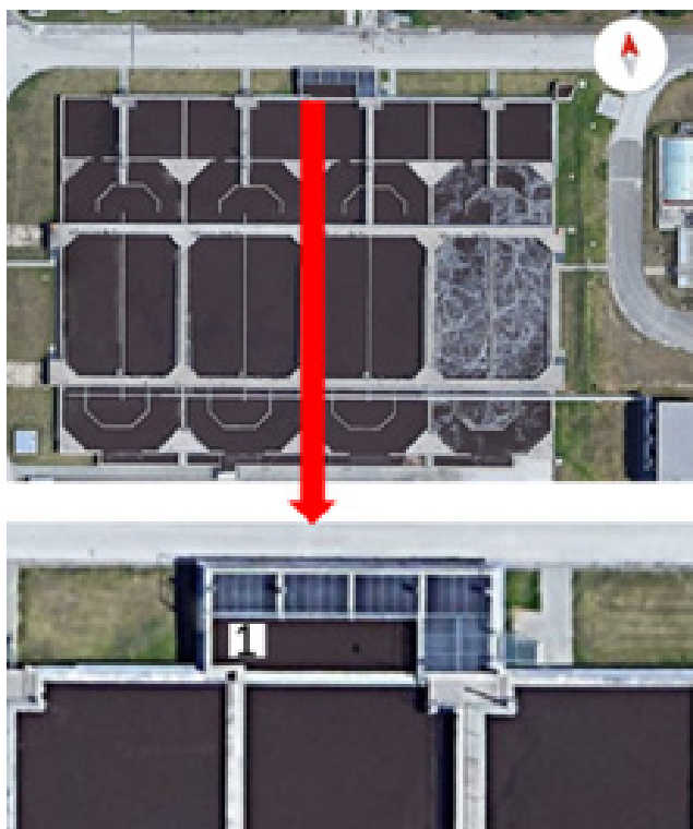
5. ábra – A 2. vonalon található osztó aknák. 1 – (6 x 1 mintavétel helye) – napi terhelési csúcs megállapításához felállított mérési sorozat helye.
