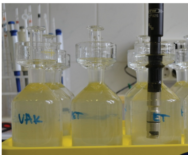
1. ábra A Karlsruher-palack oxigénelektóddal (balra), és BOI5 vizsgálat OxiTop® rendszerrel (jobbra)
