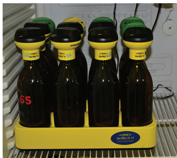
1. ábra A Karlsruher-palack oxigénelektóddal (balra), és BOI5 vizsgálat OxiTop® rendszerrel (jobbra)
