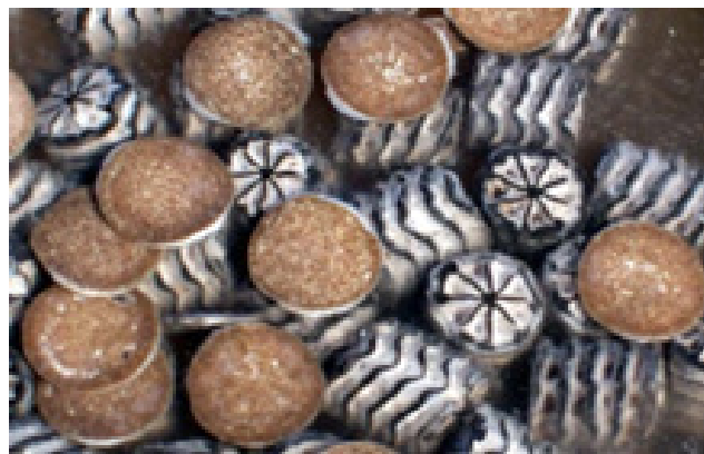
7. ábra. Klasszikus Kaldnes töltet (fenti kép), valamint többretegű biofilm hordozó a legkorszerűbb biochip lemezekkel (bal oldali kép).
