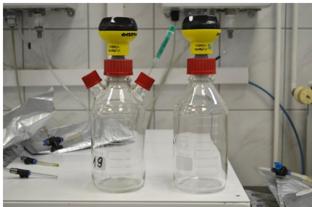
2. ábra Az OxiTop® Control AN6/AN12 mérőrendszerrel végzett vizsgálatokhoz használható üvegedények (balra) és a befecskendezés a több nyílású üvegbe (jobbra)
