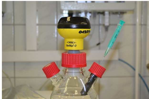
2. ábra Az OxiTop® Control AN6/AN12 mérőrendszerrel végzett vizsgálatokhoz használható üvegedények (balra) és a befecskendezés a több nyílású üvegbe (jobbra)
