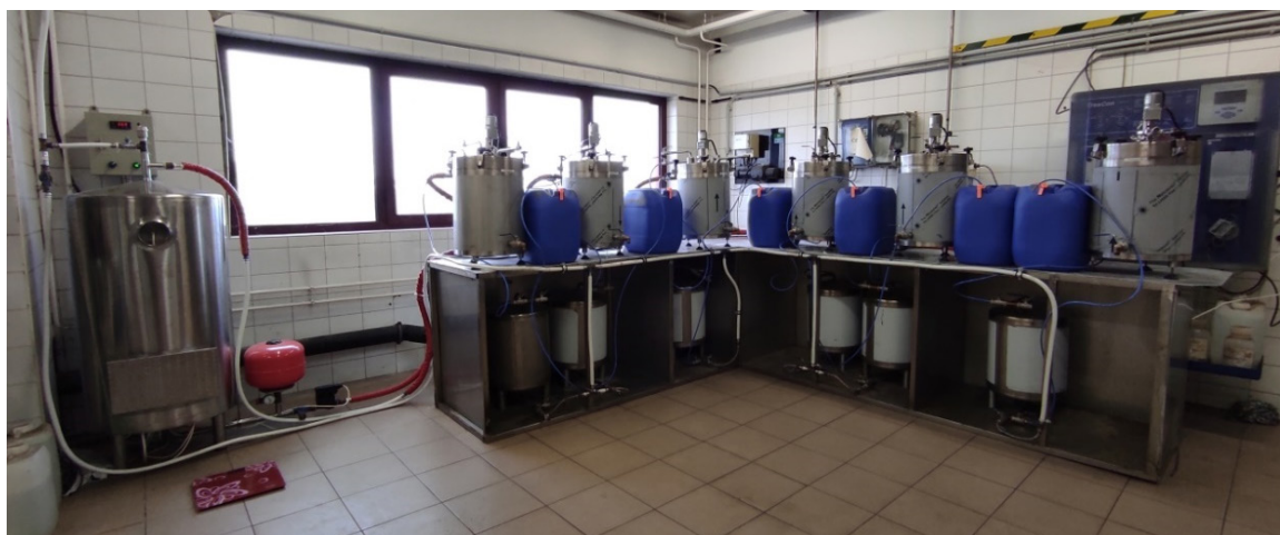
8. ábra Laboratóriumi fermentációs reaktorrendszer
