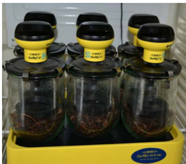
2. ábra Az eredetileg talajlégzés-mérésekhez fejlesztett WTW OxiTop® Control B6/B6M rendszer
