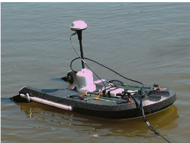
3. kép Folyók és folyamok áramlás- és mederprofil mérő műszere
