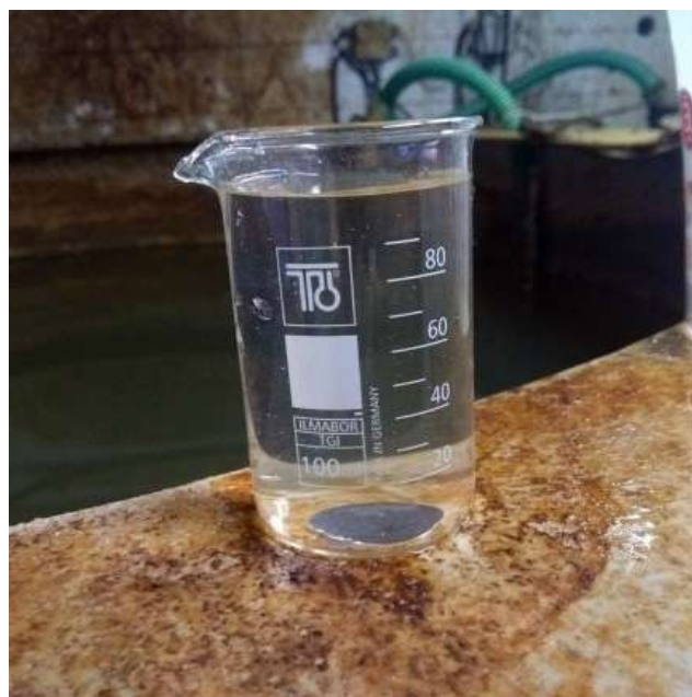
7. ábra –Prés csurgalékvíze a préslepek és a szűrőtextíliák cseréje után
