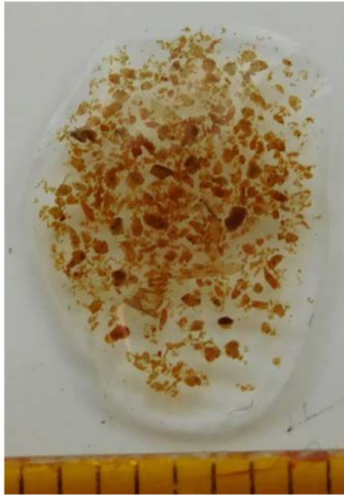
4. → ábra: Az élelmiszeripari granulált-izapos SBR-izapjának a szétterült, kiüledett izapcseppjéről készített fényképfelvétel (1 skálaosztás 1 mm).
