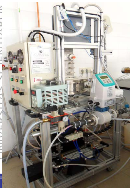
Folytonos anyagtovábbítású mikrohullámú kezelőrendszer
